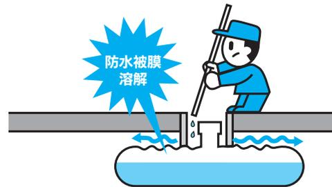
検尺棒による計量は、こぼれた油が少量ずつマンホールを経て地下に浸透しています。タンクの防水被膜を溶かし、また地下水への油の浸透など、環境問題が生じる恐れがあります。毎日の計量は安全で手軽な自動液面計で!
