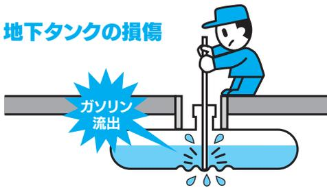
検尺棒では異種金属接触によるイオン化傾向現象(電蝕)が介在し、タンク底板を予想外に損傷しています。液面計でタンクを保護しましょう。
