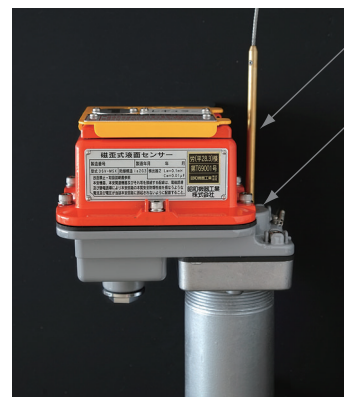
専用検水口からのワイヤー式 検水棒による測定
