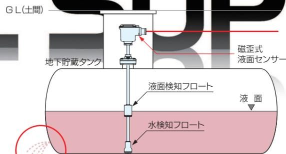
**センサー部を脱着することなく、タンク内の水位等が測定可能な専用検水口を装備** **I II**
