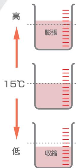
**液温を自動的に15°C換算する温度補正機能内蔵** **I II**
