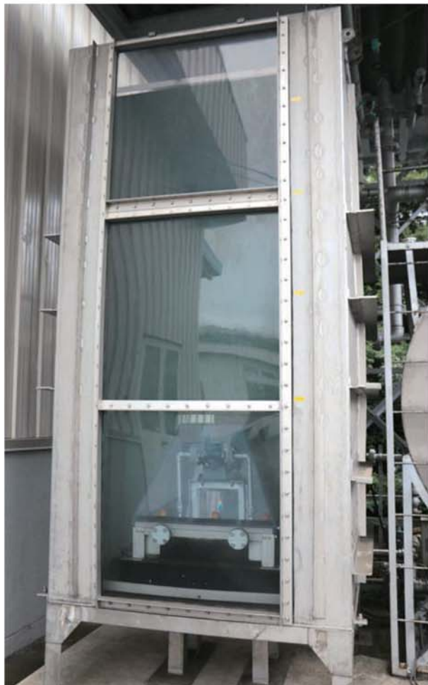
冠水した状態でも内部の水位上昇を抑える（水深3層の水槽に設置しての水没試験）
